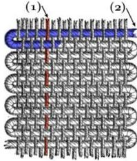
Основу ПВХ тканей составляет поливинилхлоридная пленка, с ультрафиолетовым стабилизатором, армированная сетчатой тканью, изготовленной из пряжи на основе полиэстерного волокна.
